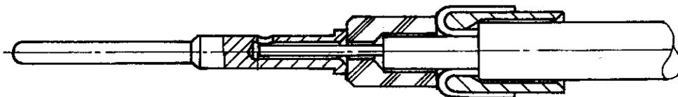
Enfiler le manchon sur le diélectrique et le contact central sur l'âme
